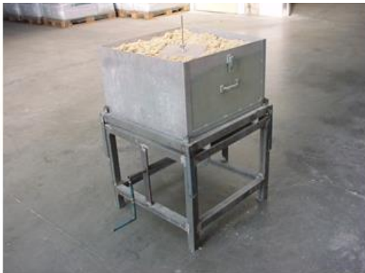
Setzungstest loser Dämmstoff
