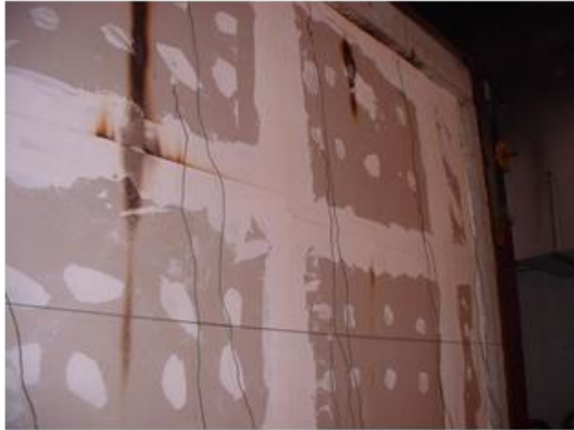
Brandversuche Strohwandelement MPA D0
