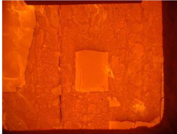
Brandversuche Strohwandelement MPA D0
